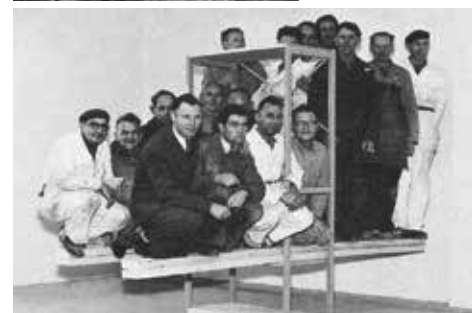
Mitarbeiter von Lundia, wie sie in den 50er- Jahren die Tragfähigkeit eines Regalbodens testen.
